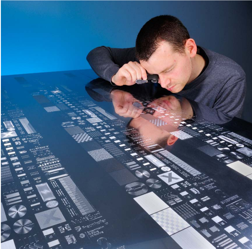
Fig. 2: Sichtprüfung und Qualitätskontrolle der gravierten Druck- und Funktionselemente (© Saueressig GmbH + Co. KG)
